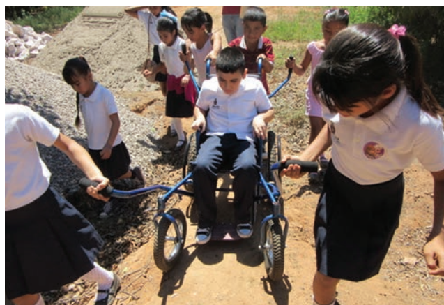
La foto superior muestra una silla de ruedas “araña” todo terreno construida para que un niño pueda atravesar terrenos irregulares y llegar a la escuela en una zona rural de México. Las proyecciones permiten a otros niños ayudar a empujar y jalar la silla de ruedas. - Foto con permiso de HealthWrights
