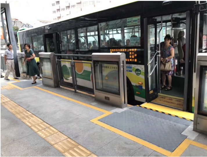
Plataforma para salvar la brecha desplegada en la estación BRT de Yichang
