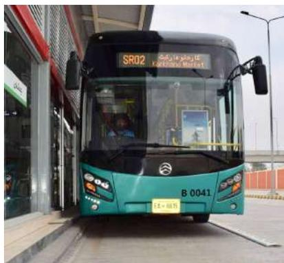
Esto se combina con un "Bordillo Kassel" en el lado de la estación para proporcionar un buen ajuste entre la estación y el vehículo, visible en esta foto. Finalmente, hay un
