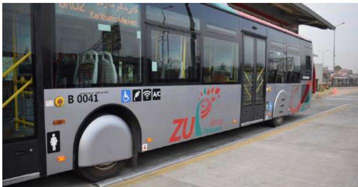
El sistema utiliza un concepto conocido como "bordillo de alineación" que dirige físicamente al bus al lado de la plataforma, como se muestra en
