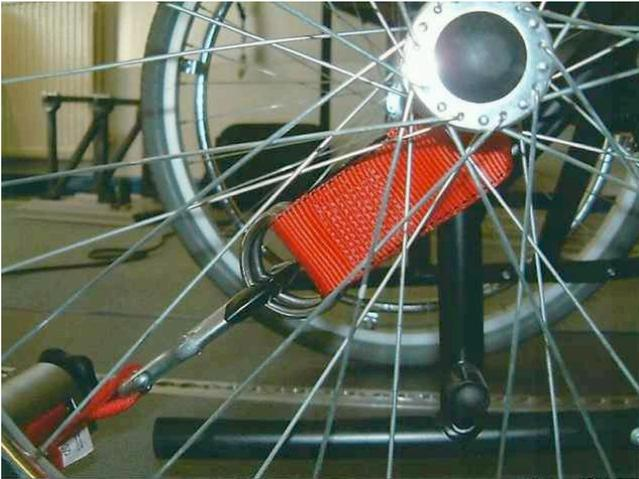
Generalmente los amarres delanteros son los primeros en colocarse. Se colocan después los traseros, tensionándolos para obtener una silla estable.
