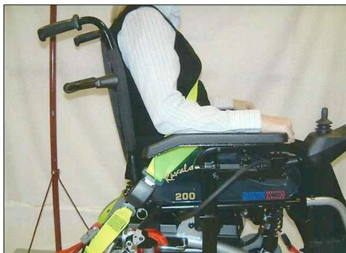
El cinturón pélvico debe estar colocado en la parte superior de los muslos del pasajero. Cuando se ve desde el lado, como se muestra en la foto de la izquierda, el largo de la correa pélvica debe formar un ángulo de 45° a 75° con la horizontal. Este ángulo minimizará el riesgo de que el cinturón pélvico se suba al estómago y cause lesiones por intrusión abdominal.
